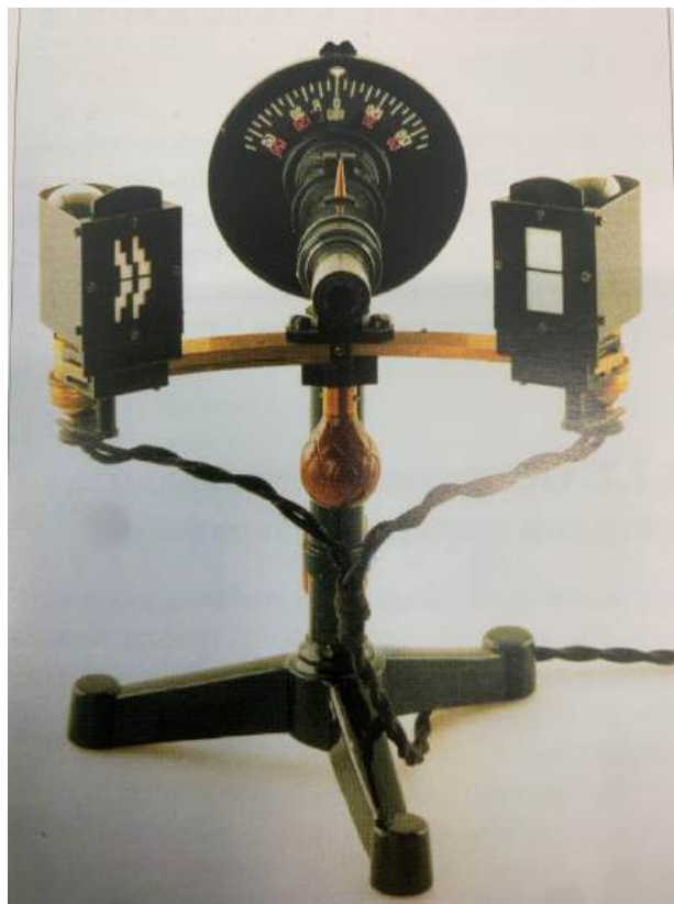
Рис.1. Так выглядит один из первых вариантов офтальмометра Жавалья
