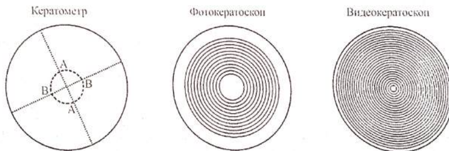
Рис.2. Схема измерения формы роговицы с помощью кератометра, фотокератоскопа и видеокератоскопа
